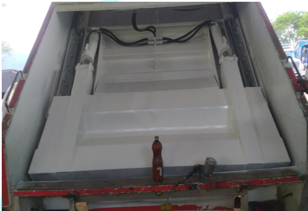
Daño de la Cuchilla
